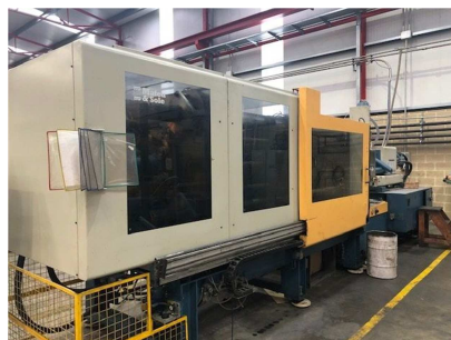
Inyectora termoplástico 400 ton.Variador freq.
