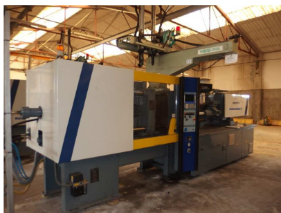
Inyectora horizontal 180 ton.Robot YMA BATTENFELD BK:T 1800/1000 Ref: 17570
