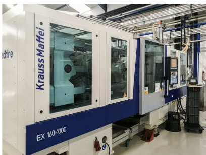
Inyectora horizontal 160 ton FULL ELECTRIC KRAUSS MAFFEI KM 160-1000EX Ref: 17445
