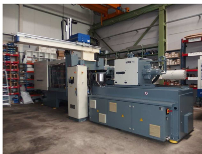
Inyectora termoplástico 450 ton.robot SEPRO opc. BATTENFELD BA 4500-1900BK Ref: 17546
