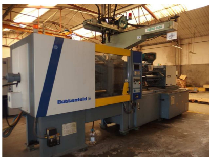
Inyectora horizontal 180 ton.Robot YMA BATTENFELD BK:T 1800/1200 Ref: 17569
