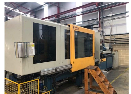
Inyectora termoplástico 400 ton.Variador freq.
