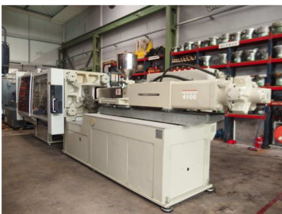
Inyectora termoplástico 480 ton.
